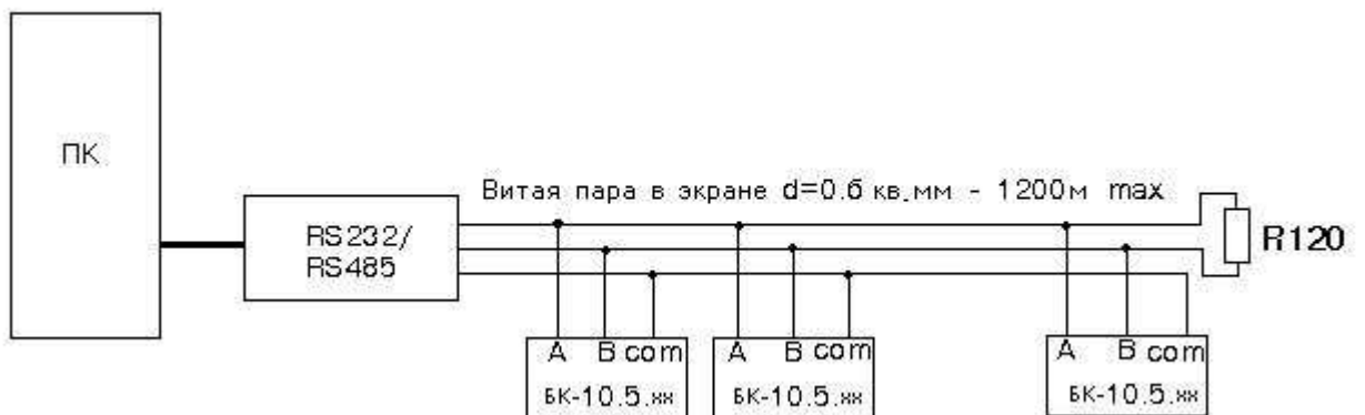
Рисунок 6. Схема подключения БК-10.5.хх по RS485.
