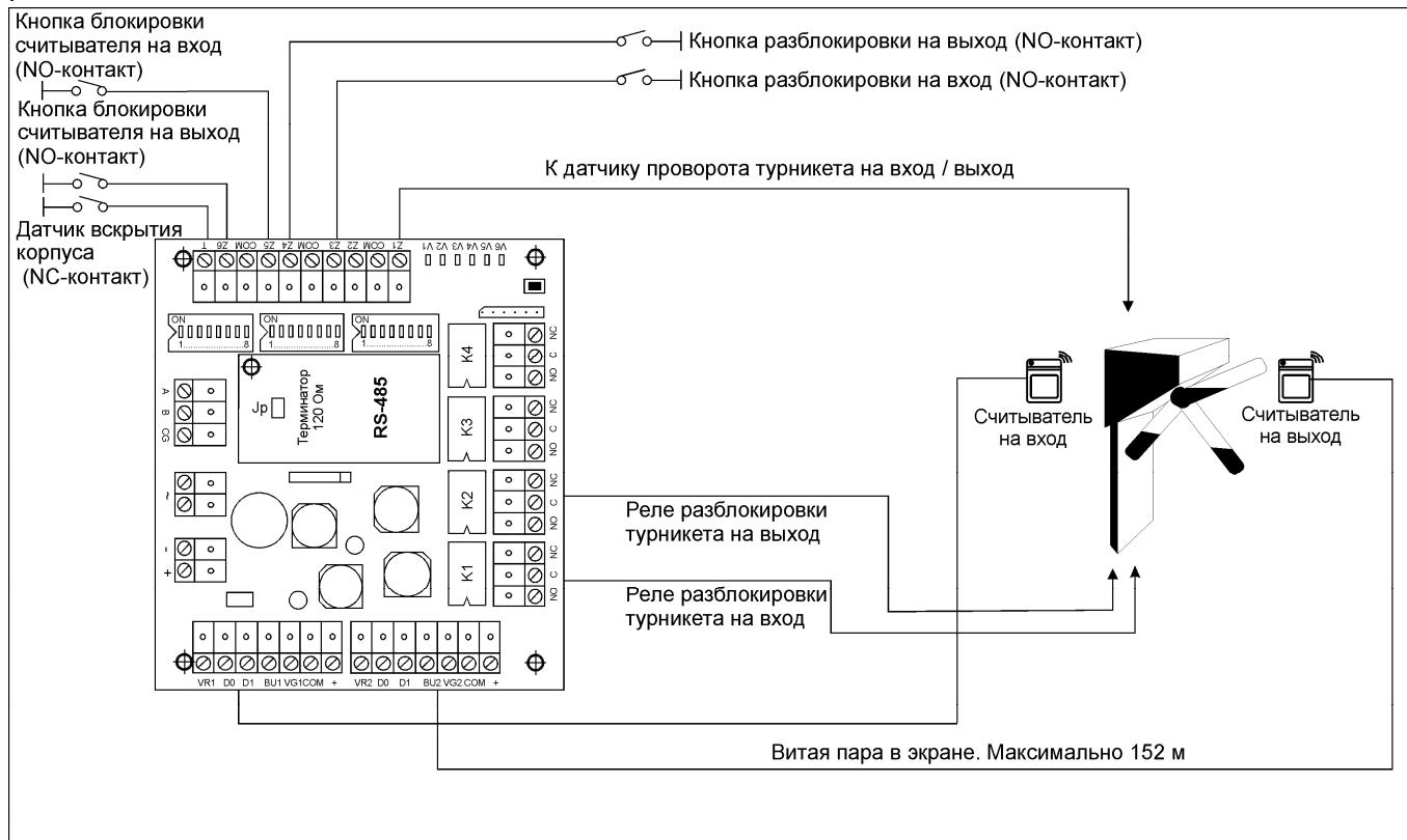
Рис 11.Функциональная схема оборудования точки прохода на основе турнекета с получением общей информации о факте прохода. Вариант.
