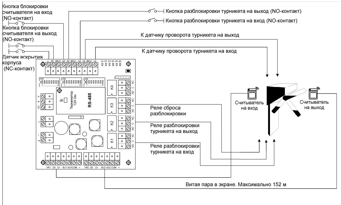
Рис 12.Функциональная схема оборудования точки прохода на основе турнекета с независимым получением информации о факте прохода по входу и выходу. Вариант.
