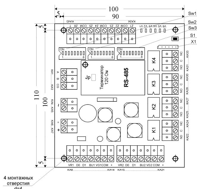
Рис.3. Общий вид контроллера с модулем RS-485 (RSG-485).
