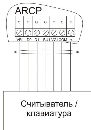
Рис.5. Подключение считывателя по интерфейсу Weigand.
